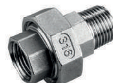
1196-13 Verschraubung 1/2" - 1/2", IG/AG mit Überwurfmutter für einfachere Montage, selbstdichtend Screw connector 1/2" - 1/2", female/ male with turning nut for easier instal- lation, self sealing
