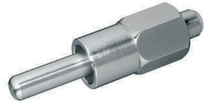
10092-13 25 Trognippel 1/2" für Sauen, Wasserfluss bis zu 12 ltr./min., mit 1/2" Innengewinde Trough-nipple 1/2" for sows, water flow up to 12 ltr./min., with 1/2" female thread
