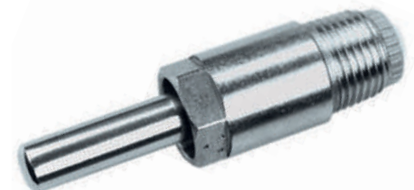
10092-14 200 Trognippel 1/2" Für Sauen, Wasserfluss bis zu 12 ltr./ min, mit 1/2" Außengewinde Trough-Nipple 1/2" For sows, water flow up to 12 ltr./min., with 1/2" male thread
